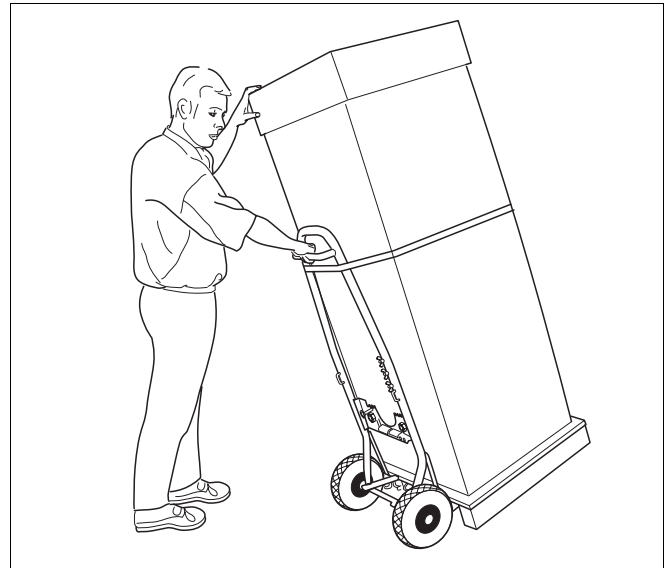
Fig. 14 Trasportare la caldaia Logano G135(T) con l'imballaggio, sul pallet di trasporto, con la cinghia di fissaggio
