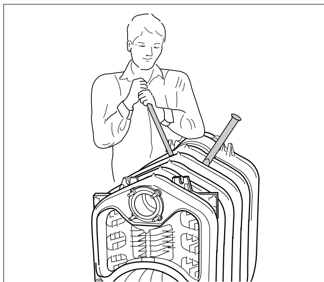
Fig. 27 Separarea blocului de cazan
