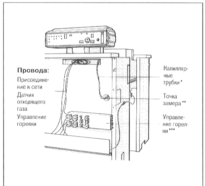
Рис. 40 – передняя сторона котла со снятой передней стенкой
